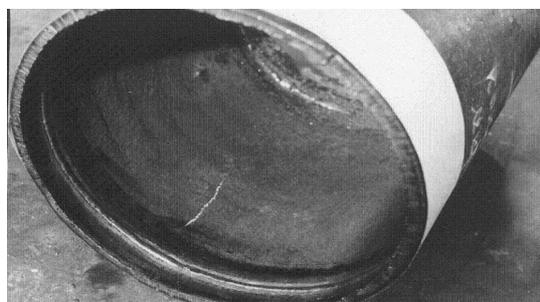
Рис. 3. Внешний вид стыкового шва с обратной стороны
